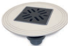
KRASO® Afvoerput binnen-/parkeerplaats Type 1,5 met inmetselfbare flens met zwaluwstaartgroef (alleen voor bitumen bedekkingen, niet voor hars coatings)
