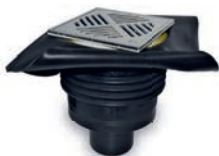
KRASO® Afvoerput binnen-/parkeerplaats Type 1,5 met roestvaststalen rooster met folieflens
